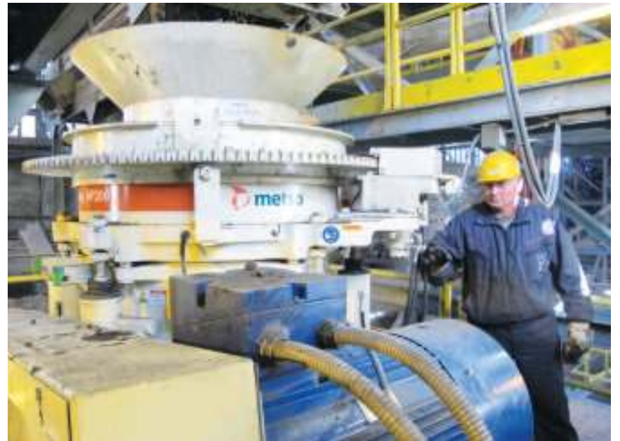
Дроби и просејава 150 тона шљаке на сат
